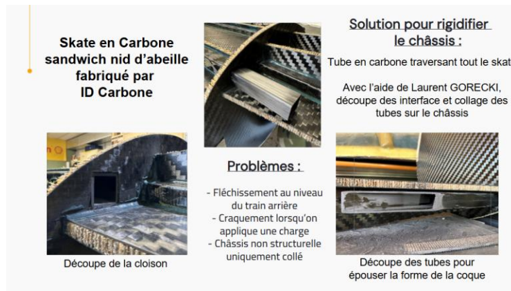
Figure 3: Renforcement du châssis
